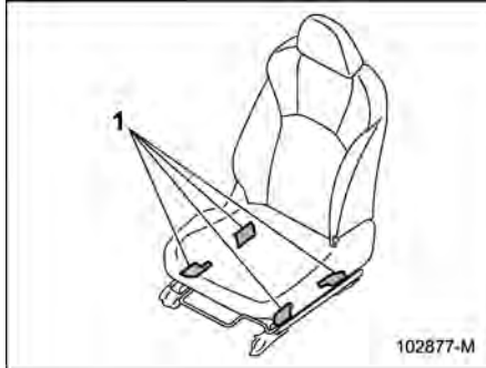
1 Sensori di riconoscimento occupante
